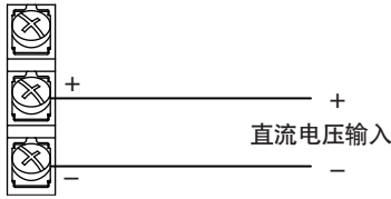
直流电压输入以及DI(ON/OFF)输入
