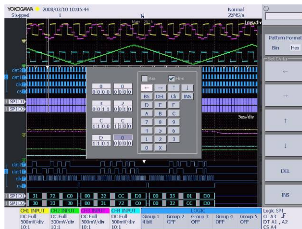
特定のバス値の波形部分を波形メモリから高速サーチ (SPIバス上のデータ値"0032CCD"をサーチした例)
