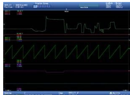
图3: 解码过的SENT传感器数据的趋势 (DL850EV示波记录仪)
