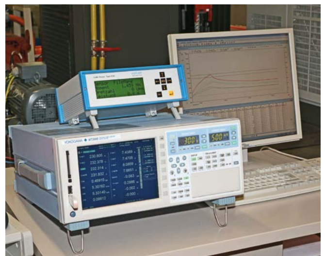
Die Signale der Drehmomentmesswelle gehen über ein Auswertegerät (steht auf dem WT3000) direkt in den Leistungsanalysator. Auf dem Bildschirm daneben werden zur Kontrolle die Temperaturmesswerte angezeigt.
