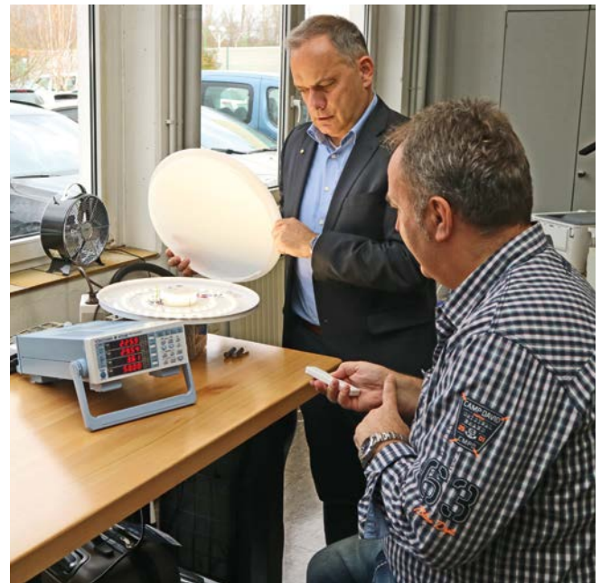
Hilarius Müller (rechts) und Michael Müller-Wachter (Yokogawa) bei der Messung des Energieverbrauchs einer LED-Deckenleuchte mit dem WT310E.
