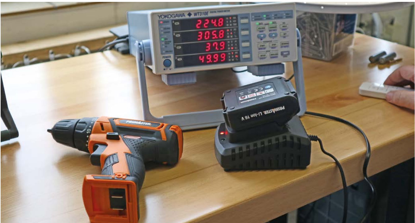
Am Netzteil eines Akkuschaubers wird die Leistungsaufnahme sowohl beim Laden des Akkus als auch bei vollgeladenem Akku überprüft.
