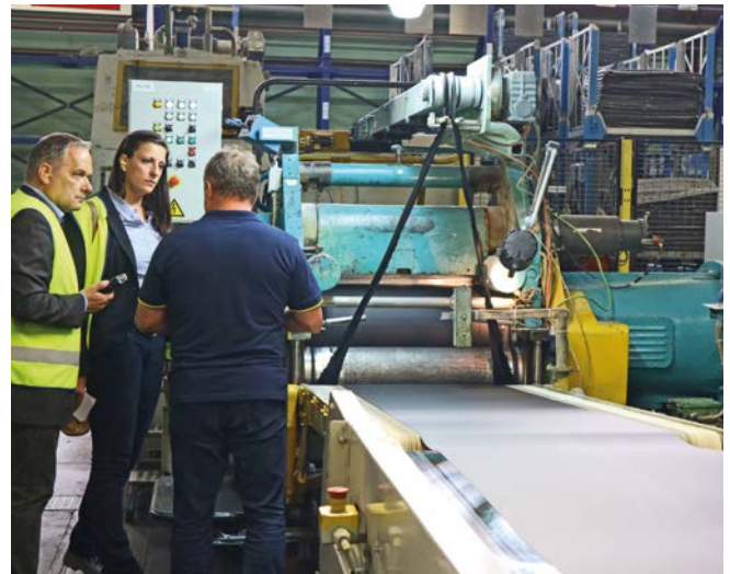
Diese Anlage produziert mit einem Extruder die innere Gummilage für Lkw-Reifen. Das Gummiband wird nach kurzer Abkühlung auf großen Rollen aufgewickelt und später auf die benötigte Größe zugeschnitten.
