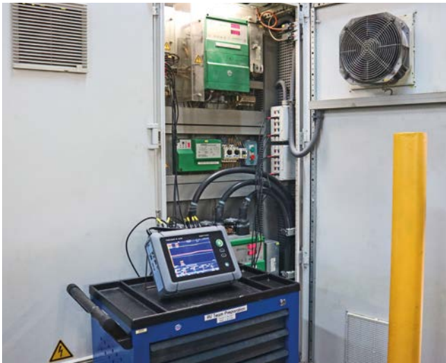
Erfassung von Regelsignalen der SPS.
