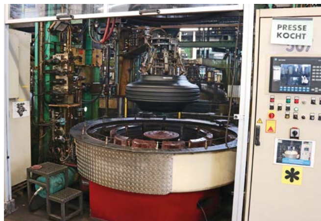
In der Reifen-Kochung wird der Rohling von oben in die Vulkanisationspresse eingelegt, dann die Form mit einem Deckel verschlossen und der Reifen unter Druck und Temperatur in die endgültige Form und Konsistenz gebracht.
