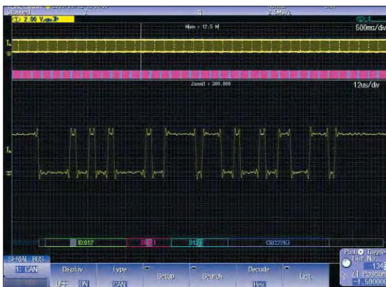
Bild 9. Eine 12,5-MPunkte-CAN-Kurve (Dauer 5 s) und Zoom-Fenster.
