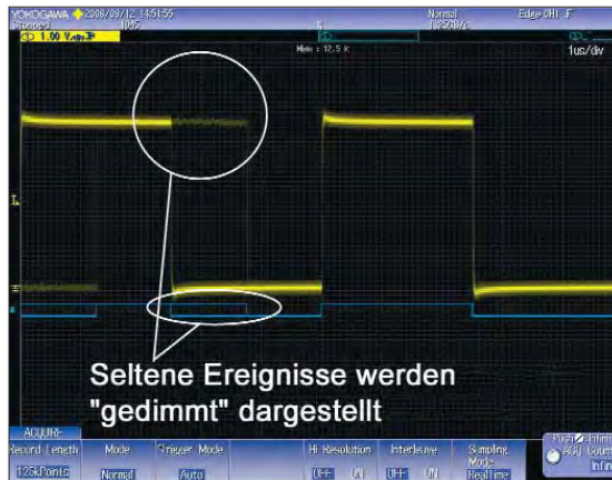
Bild 3. Die Signaldarstellung repräsentiert in ihrer Helligkeit auch die Häufigkeit des Auftretens dieser Signal-Kurvenform: Selten auftretende Signale und deren Veränderungen erscheinen „gedimmt“, häufige Signaldetails entsprechend heller.
