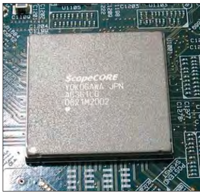
Bild 2. Der ScopeCORE-Prozessor ist das datenverarbeitende Herzstück der neuen Oszilloskop-Serie. Details zu seiner Funktion siehe Text.
