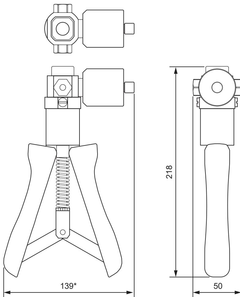
外形寸法は、ハンドルのストローク調整によって、多少変化します。
