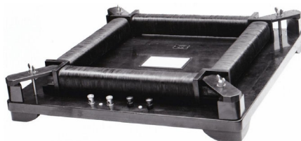
図1. 横河電機製作所が1935年に作ったエプスタイン試験枠
