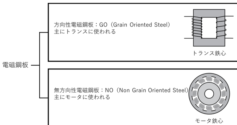
図5. 方向性電磁鋼板と無方向性電磁鋼板
