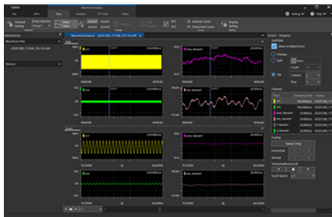
DL950波形データとWT5000電力データの同期表示例
