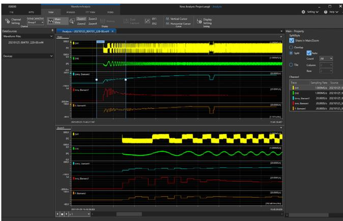
図5 電力データと波形データの同期測定画面
