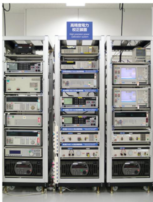
図2 従来の電力校正システム外観
