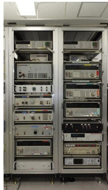
図4 新電力校正システム外観
