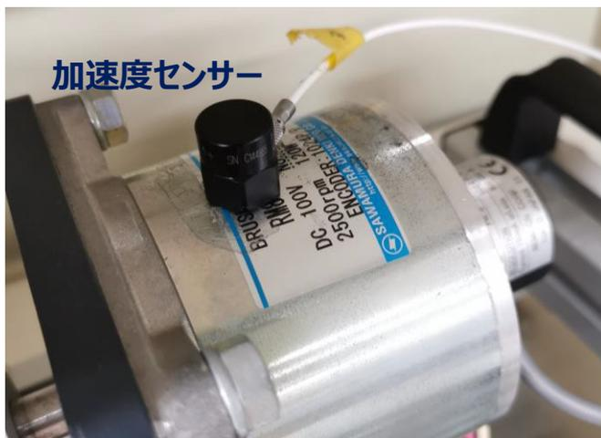
モーターに加速度センサーを取り付け、DL850Eで振動を測定。
