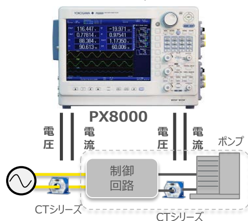
PX8000による瞬時電力/入出力効率測定
