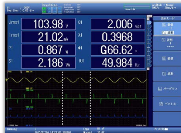
カーソル区間だけの電力測定 *
