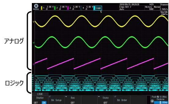
アナログ信号とロジック信号の同時観測例
