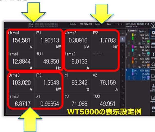
直流交流変換器から出力された商用電源 (100V、50Hz/60Hz) の信号を測定
