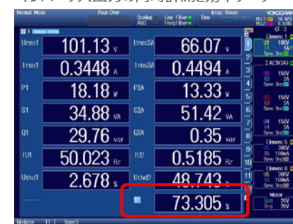
インバータ入出力の同時計測と効率データ
