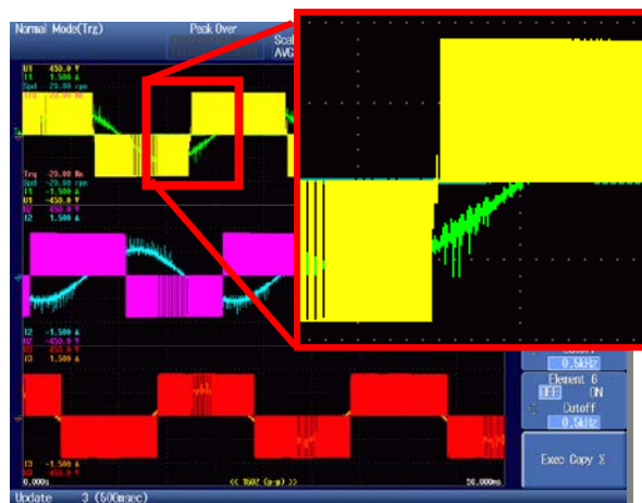
インバータ信号の波形観測例
