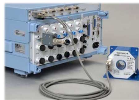
WT1800Eと電流センサー用電源との接続
