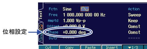
前のステップの波形が DC またはノイズだった場合、次のステップは位相  $0^\circ$  から発振を開始します。
