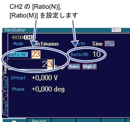
Oscillator 画面で、チャンネル2の [Ratio(N)], [Ratio(M)] で周波数比を設定します。チャンネル2の周波数:チャンネル1の周波数が、N:Mになります。周波数比を変更すると、両チャンネル共、発振を一旦停止しますので、位相は一時的に不連続になります。
