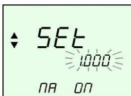
図 3-5 NA補正係数設定時の表示例
