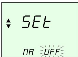
図 3-4 NA 補正係数設定 ON/OFF 画面の表示例
