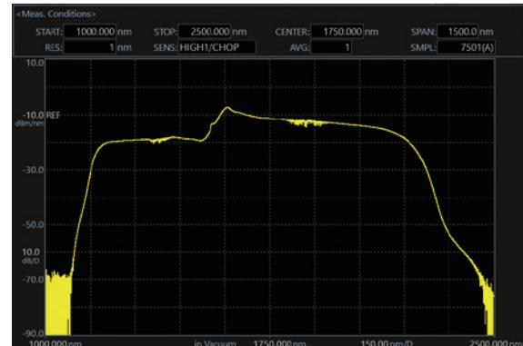
2 μm帯スーパー・コンティニウム光源の測定例
