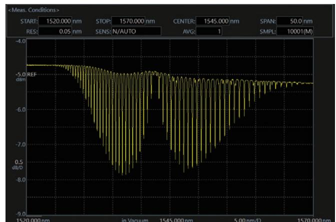
シアノ化水素 H<sub>13</sub>C<sub>14</sub>N の光吸収スペクトル測定例 (AQ6375E)
