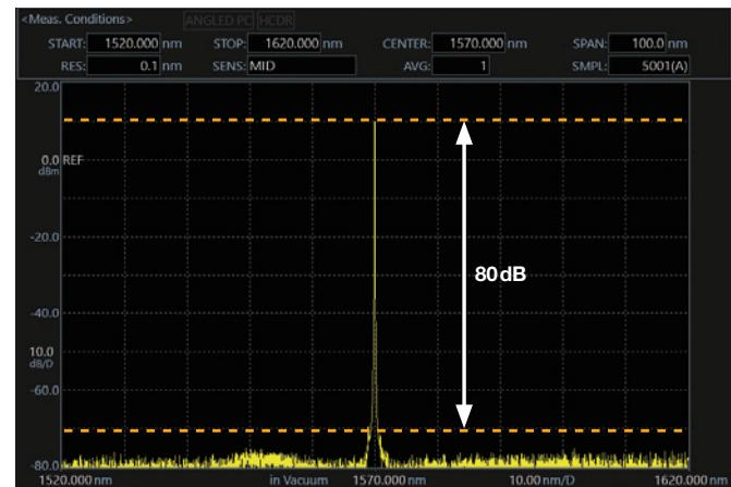
図2 迷光抑圧比の例 (AQ6370E-20)
