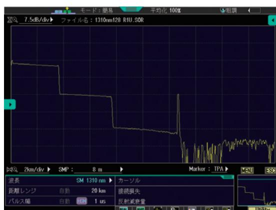
HSNモードにて128分岐を測定した例
