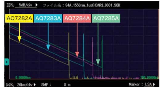
パルス幅 1μs の OTDR 波形例
