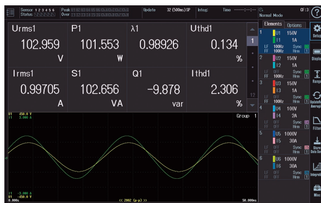
図5 電圧、電流、力率、THDなどの表示例
