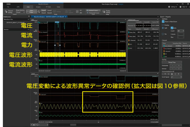
図9 IS8000による電圧・電流・電力トレンド表示
