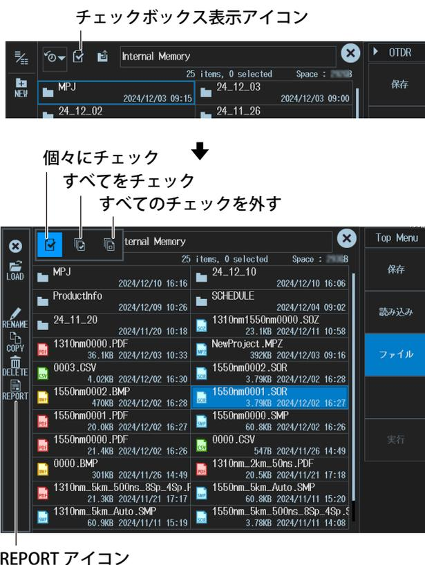
レポートの書式設定で「ファイバー端面画像」をマニュアルに設定しているか、Auto に設定していても対象の画像データ (作成するレポートファイルの通し番号と同じファイル名の画像データ) がなかったときは、ファイバー端面画像の選択画面が表示されます。レポートに表示するファイバー端面画像を選択します。
