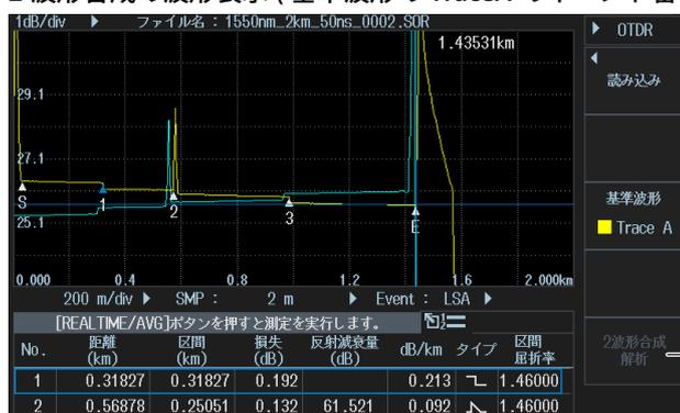
反対の地点から見た波形を一方の方向から見た波形として合成して表示します。
