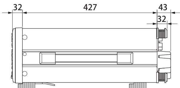
電流センサー用電源( /PD2)オプション付きのモデル
