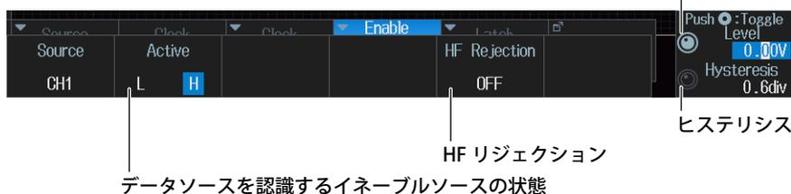
クロックソースに同期してデータソースをサンプリングするときに、データソースを認識する期間をイネーブルソースで制御できます。
