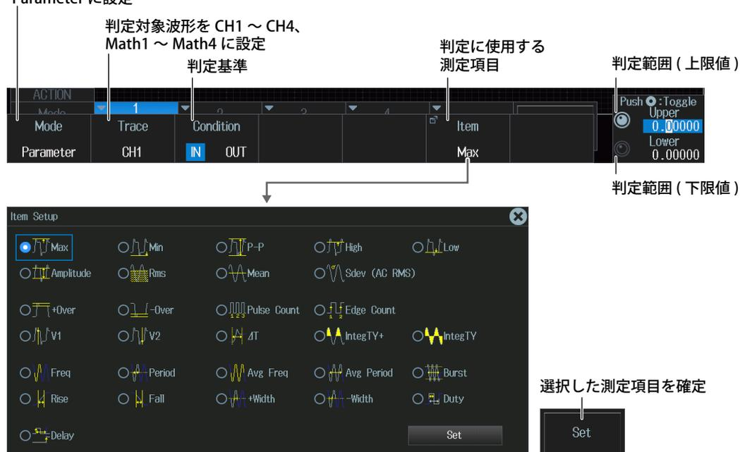
**LOGIC を判定対象波形にした場合 (ロジック信号入力用ポート付きのモデルのとき)**
