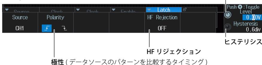
クロックソースに同期してサンプリングしたデータソースのパターンと、トリガ条件として設定したパターンを比較するタイミングを指定できます。
