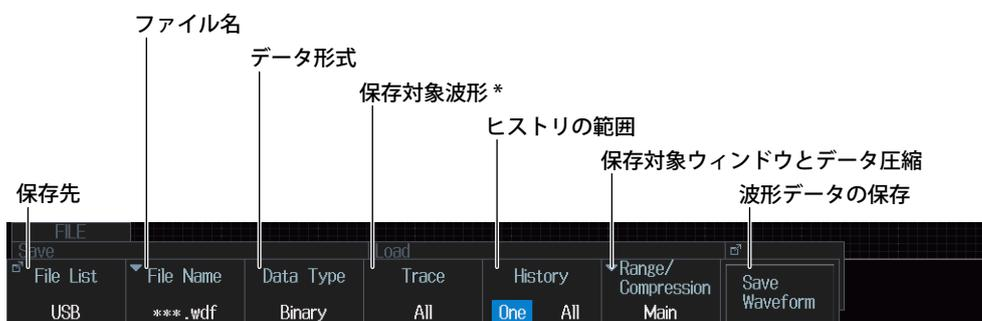
\* CH4 と LOGIC は、どちらか一方、点灯しているキーの波形に対してデータを保存できます。CH4 または LOGIC キーを押して、測定対象にするチャンネルをあらかじめ選択してください。
