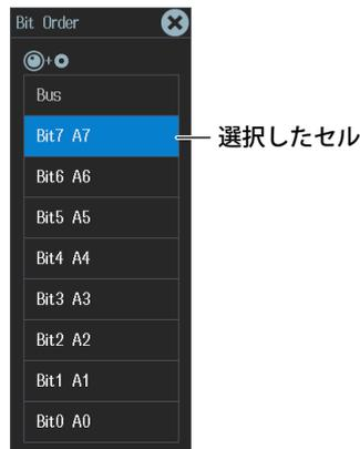
2. **Up** または **Down** のソフトキーを押して、選択したビットまたはバスを上下に移動します。選択したビットまたはバスが上下に移動するたびに、上下のビットまたはバスと順番が入れ替わります。
