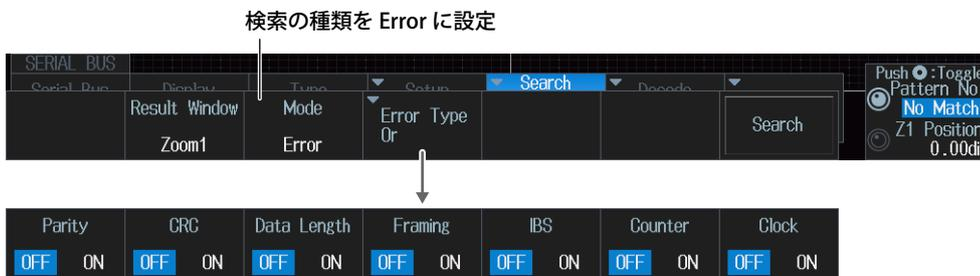
Parity、CRC、Data Length、Framing、IBS、Counter\*、Clock エラーの検出 ON/OFF
