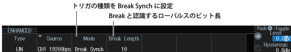
Break Field に続いて Synch Field を検出 (Break Field + Synch Field) したとき、トリガがかかります。
