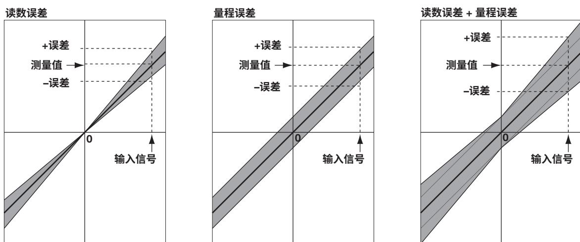
以下举例说明输入60Hz的正弦波信号时测量值中包含多少误差。
