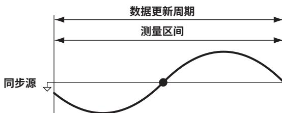
决定电压或电流最大值的数值数据以整个数据更新周期为测量区间。因此，以下从电压和电流最大值求得的各测量功能也以整个数据更新周期为测量区间。
