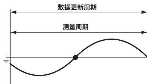
由于上述原因，电压和电流的测量值可能不稳定。如果出现这种情况，请减小数据更新率，以使包含更多周期的输入信号进入数据更新周期。
