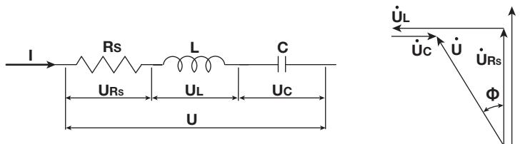
电阻 $R_s$ 、电抗 $X_s$ 、阻抗 $Z$ 的关系如下:
