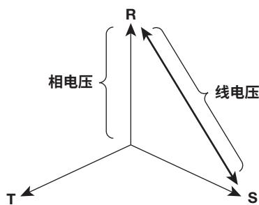
如果电源或负载使用的是三角接线且没有中性线，就无法测量相电压，但会测量线电压。使用2个单相功率计(2功率计法)测量三相交流功率时，测量线电压。如果各相的相电压大小相等且每相各偏移 $120^\circ$ ，线电压就等于相电压的 $\sqrt{3}$ 倍，相位偏移 $30^\circ$ 。
