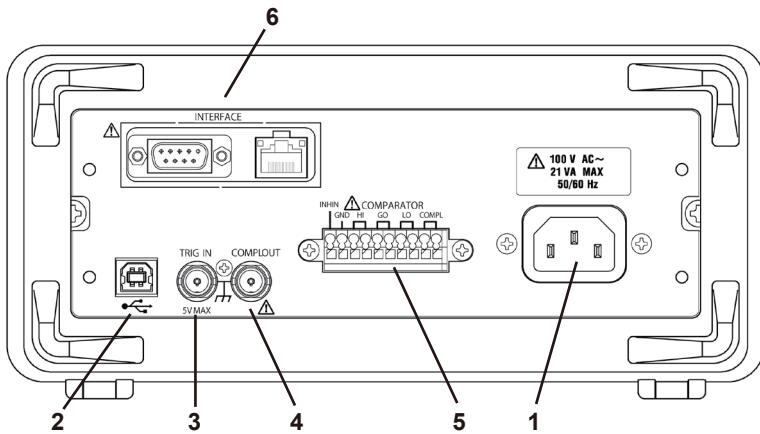
图1.7(b) DM7560后面板(主机+/C2+/CMP)
