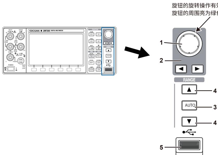
图1.6 旋钮&量程切换区
