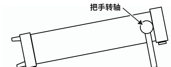
图2.1(b) 放置状态B (用把手将仪器倾斜)
