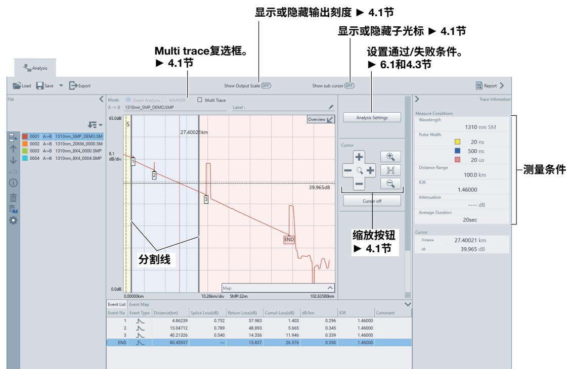
对于每个脉宽，通过组合相同波长但不同脉宽的多个波形，由此获得的波形会以不同的颜色显示。
