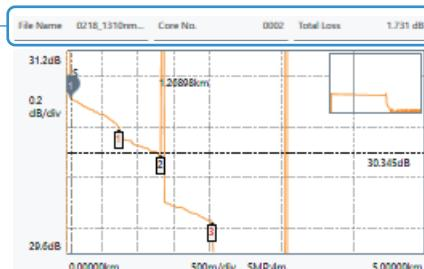
要设置波形的显示刻度和显示位置，使用Analysis窗口工具栏上的**Show Output Scale**。▶ 4.1节
