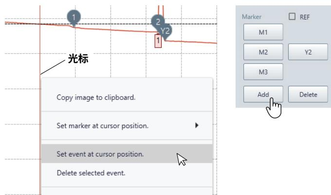
将添加事件，并自动从左侧开始放置标记M1、M2 (事件位置)、Y2和M3。所有事件号均被更新。
