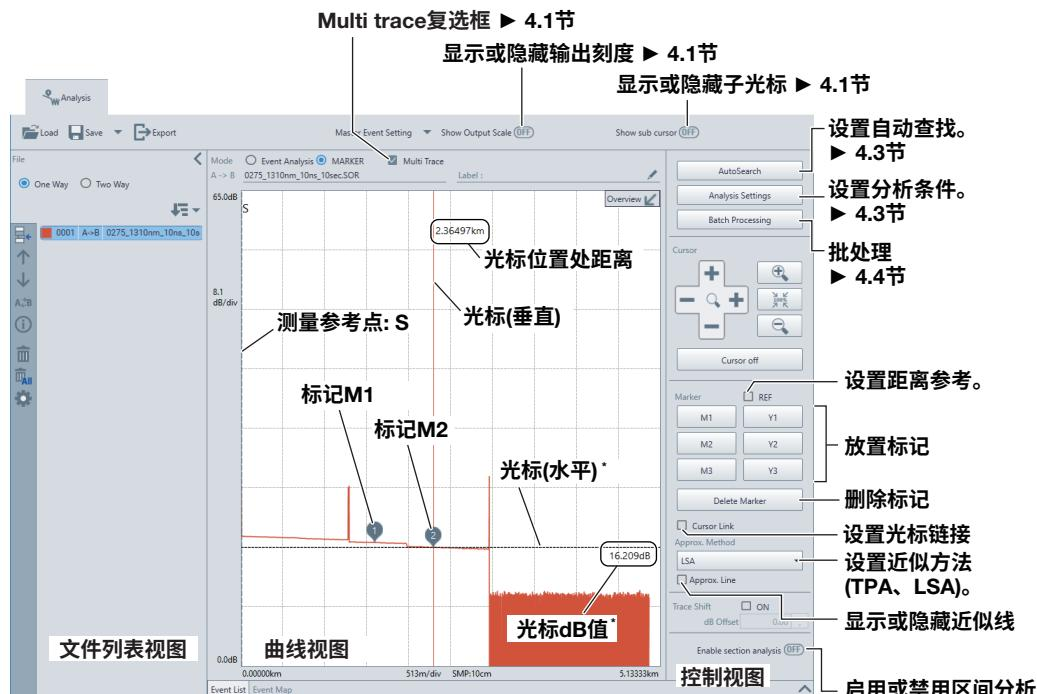
\* 使用十字光标时，将显示水平光标和光标dB值。
