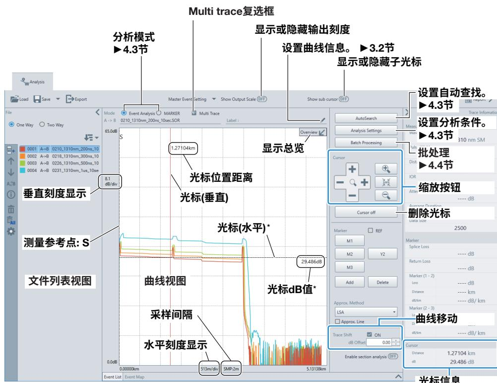
\* 使用十字光标时, 将显示水平光标和光标dB值。
