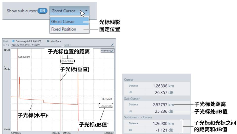
\* 使用十字光标时，“曲线”视图中将显示水平光标和光标处的dB值。可以使用**Setting**菜单的Analysis选项卡中的**Display Settings**来改变光标显示格式。► 参见9.3节
