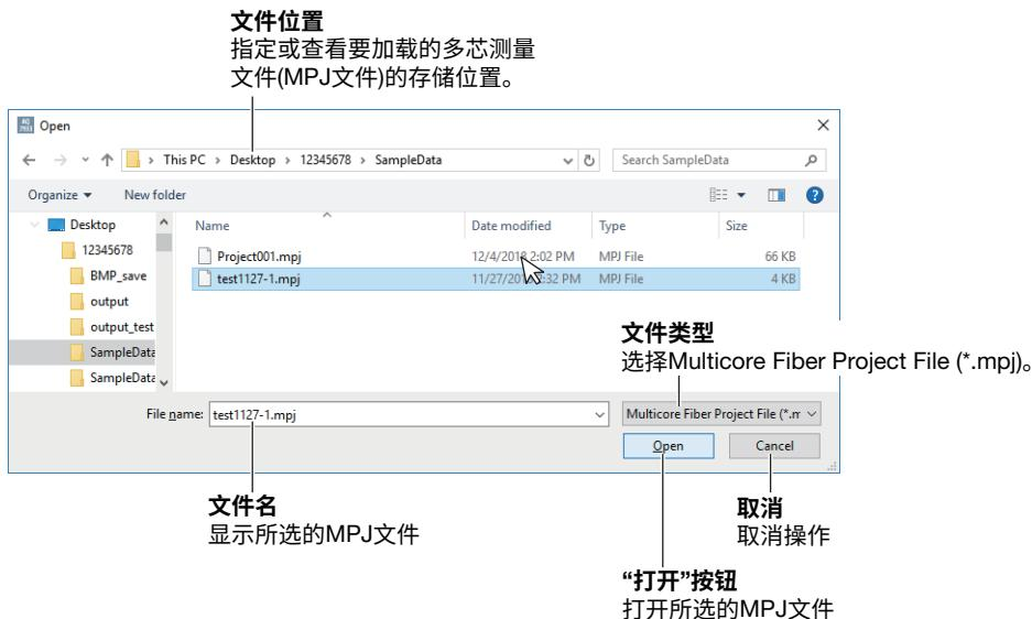
项目文件被加载。存储在MPJ文件中的组将被加载，并显示组ID。
