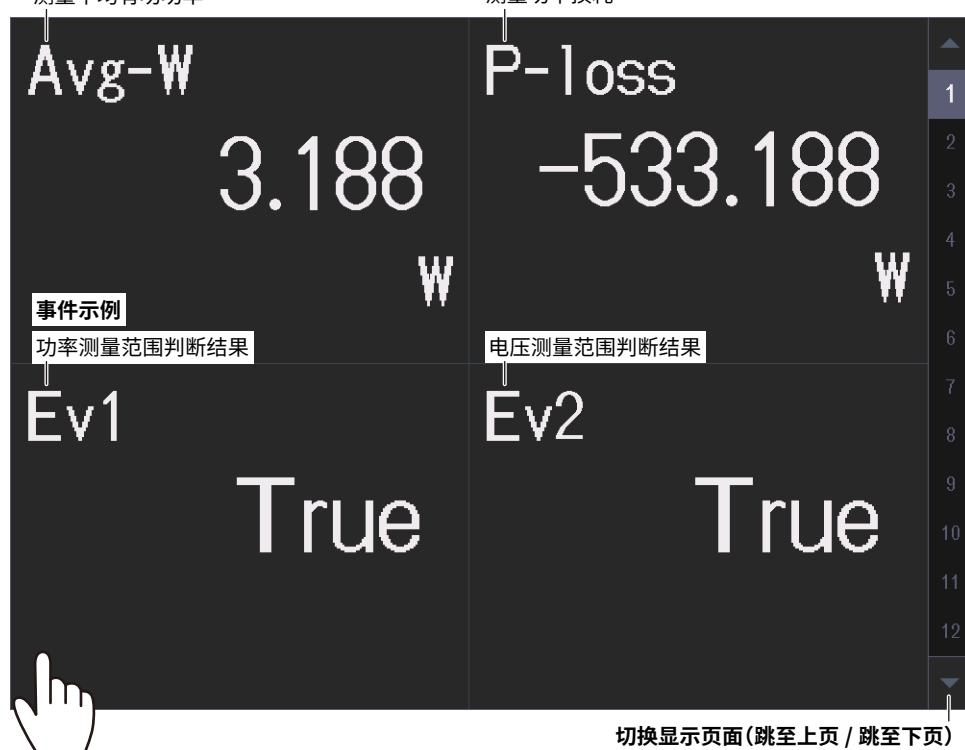
如果将手指按住 4 项显示、8 项显示、16 项显示数值、矩阵或谐波显示至少 1 秒，可执行后述“切换显示项目(项目)”中说明的操作。
