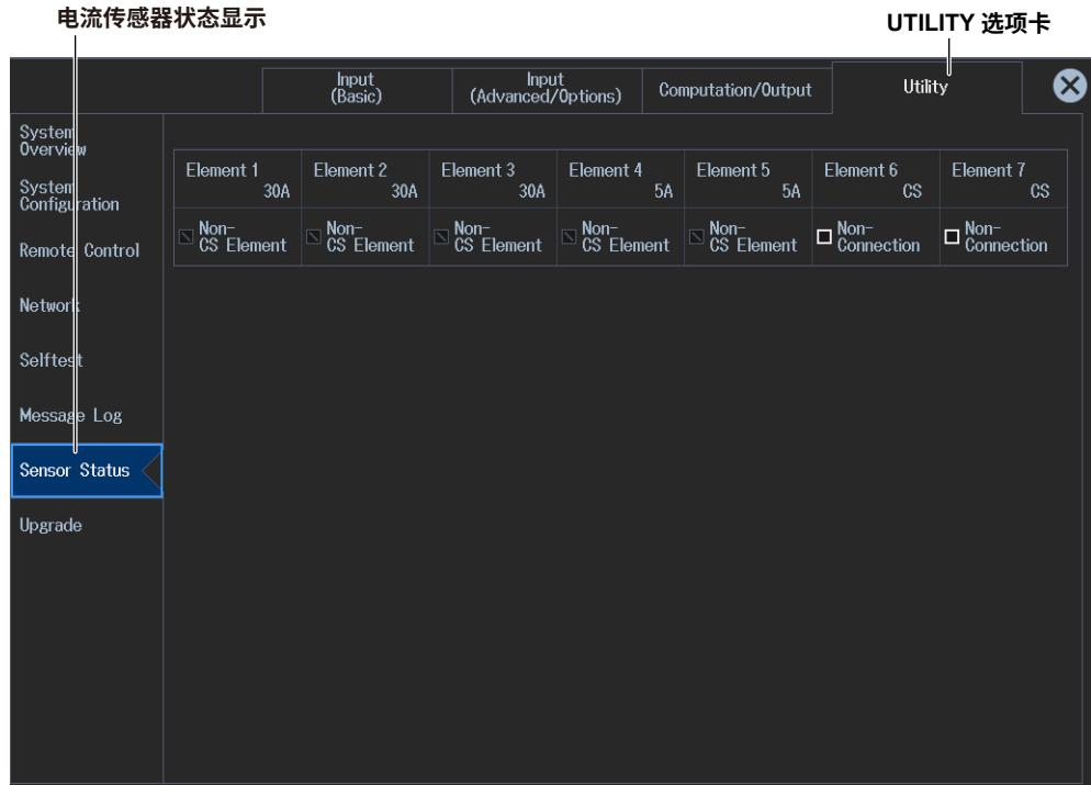
轻触屏幕左上角的传感器状态指示灯，显示电流传感器状态列表。
