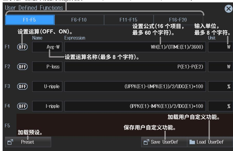
用户自定义功能设置界面每个界面显示五个功能。最多可定义 20 个功能。在设置示例中，在 F1 中设置平均有功功率的运算值，在 F2 中设置功率损耗的运算值。
