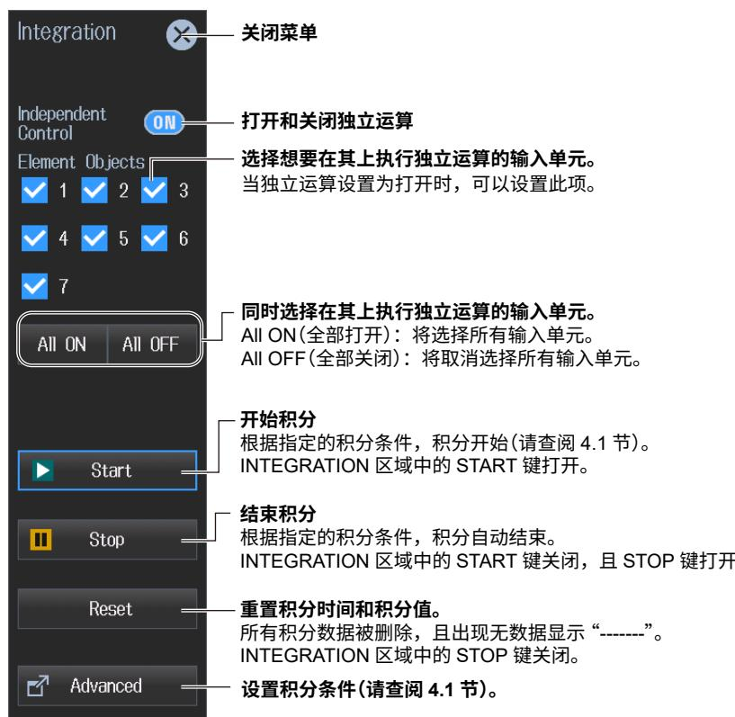
将测量模式（请查阅 1.1 节）设置为“IEC 闪变”时，积分图标将变为闪变图标。见下页。
