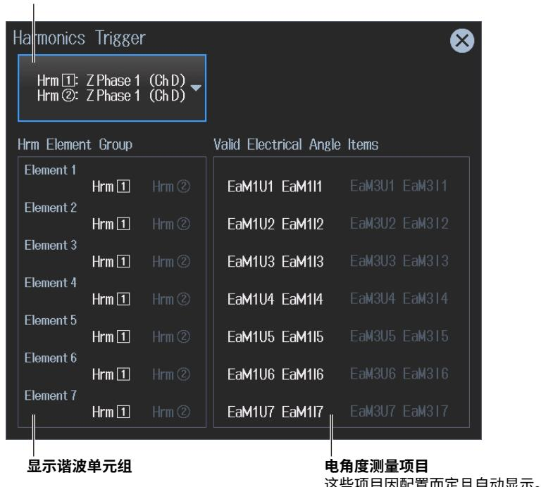
**Hrm①: Z Phase 1 (Ch D)** : 将 Hrm1 和 Hrm2 触发设置为电机 1 的 Z 相位。
