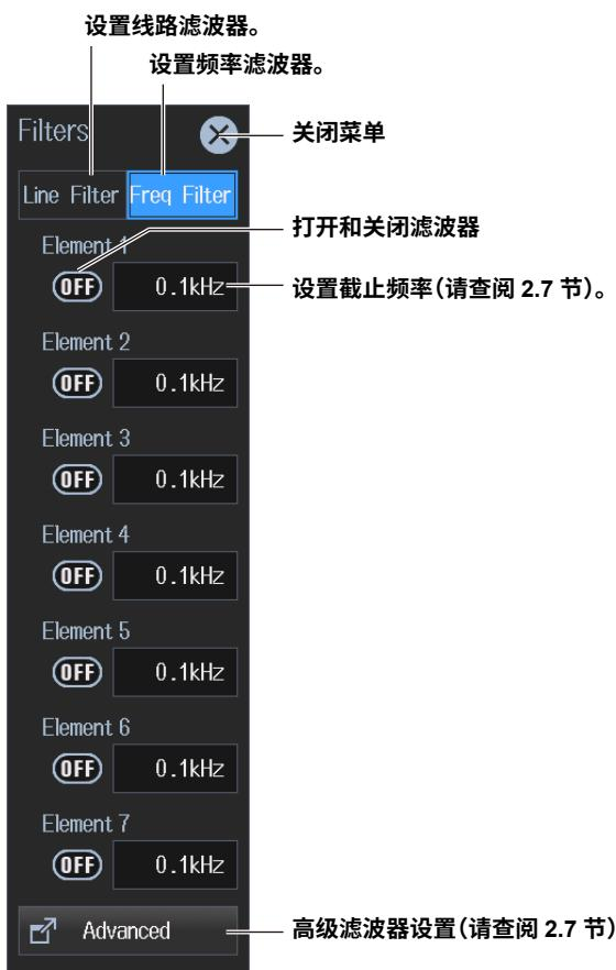
本仪器有三种测量模式(请查阅 1.1 节)。根据测量模式显示滤波器菜单。以上所示为常规测量模式的菜单。
