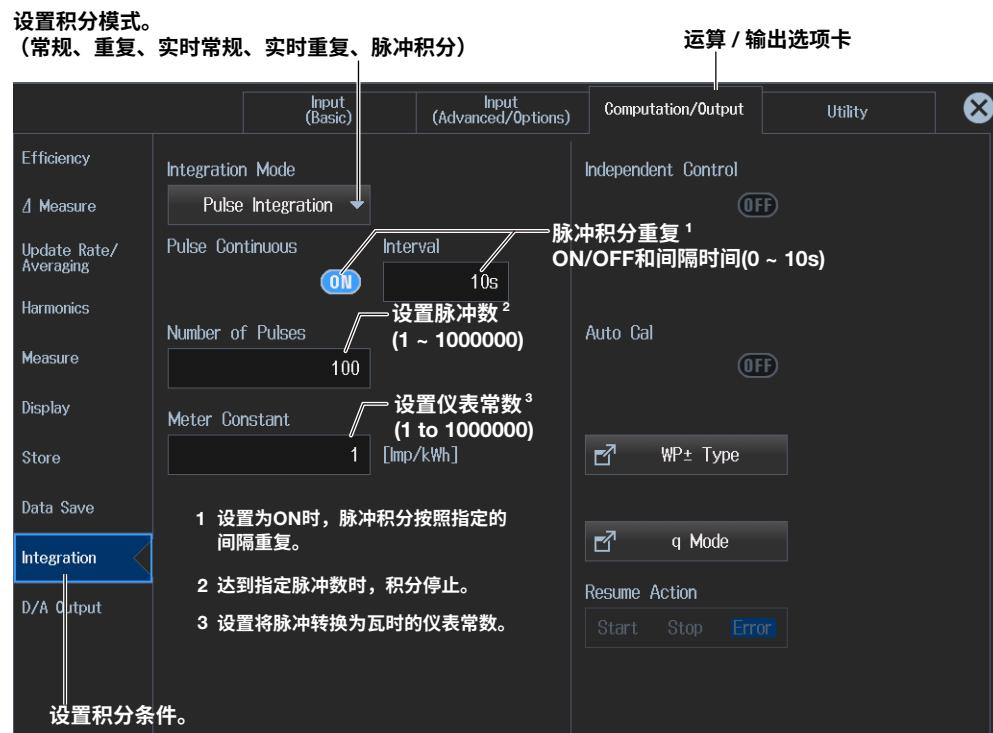
积分模式设置为脉冲积分时，独立运算、积分自动校准和断电恢复时积分恢复动作的设置不可用。
