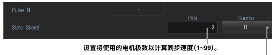
设置将使用的电机极数以计算同步速度(1~99)。
