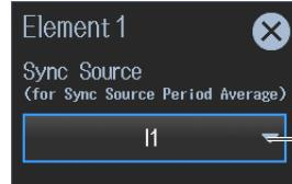
设置同步源(U1~U7、I1~I7、Ext Clk、Z Phase 1(Ch D)、Z Phase 3(Ch H)、无)。
