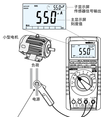
AC/DC钳式传感器(型号: 96095) 与TY500系列连接时, 最大可以显示60A。
