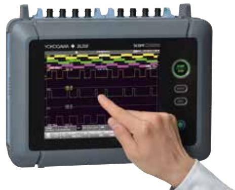
即使关闭背光并且触摸屏未激活，用户也依然可以操作START/STOP、手动触发和数据保存按键。针对那些对最新测量仪器不熟悉的用户，此仪器还能通过内置功能说明手册为他们提供快捷帮助。
