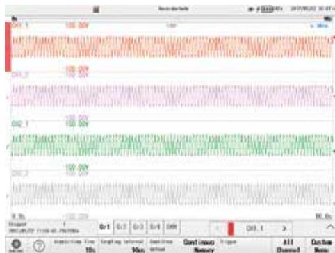
示波器模式可以让DL350像示波器那样使用，并具有全部相应的优势如全面的触发和内存的灵活使用。使用历史存储可以让多达1000个独立触发捕捉到的数据保存在内存中，并在事后进行查看。由此就可以仔细分析异常情况的原因和影响，如同翻阅相册一样简单。
