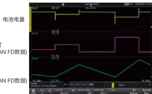
Symbol Editor是一个软件工具，它能够定义来自CAN/CAN FD或LIN总线数据帧的哪一个物理值将被作为DL350显示屏中的波形数据。Symbol Editor可以接受车辆安装的定义文件(CAN DBC、LIN LDF)
