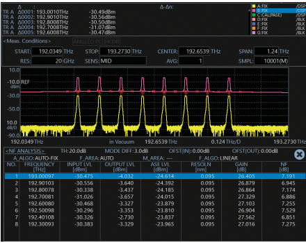
图3: 光放大器的自动例行分析提供相关参数表格
