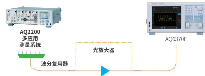
图1: 光放大器测试的典型实验设置
