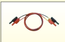
758917 测试线 每套两根。用758917连接758922或758929。 总长度: 75cm 额定: 1000V, 32A
