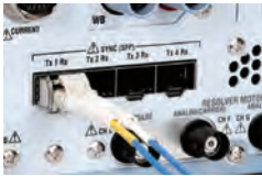
主机与从机之间通过光纤线和光收发模块连接。
