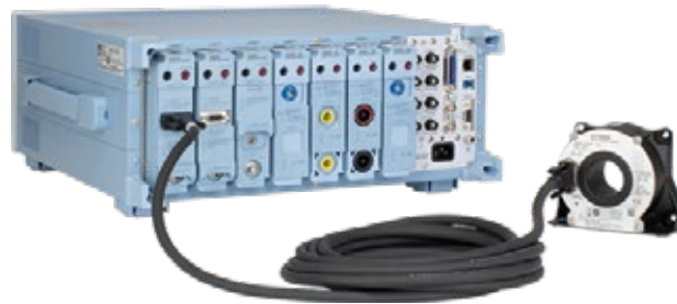
Bild 1: Mit dem neuen WT5000 Sensormodul können Stromwandler oder bspw. Stromzangen direkt versorgt werden. Messaufbauten gestalten sich dadurch deutlich einfacher, denn die externe Sensorversorgung kann eingespart werden.
