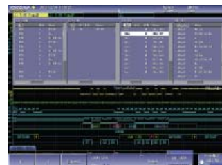
Dekodierung von vier Bussen mit Listen-Darstellung
