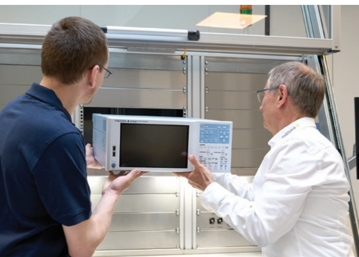
Bild 1: Der Sicherheitsmessplatz SHL (Safety Housing Lab) von SAXOGY ist modular aufgebaut und lässt sich mit unterschiedlichster Messtechnik ausstatten
