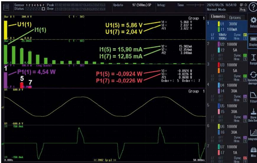
Bild 3. Kurvenformen und Harmonische am Eingang eines USB-Netzteils.
