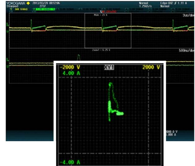
Der SOA definiert den optimalen STROM/ SPANNUNGS-BEREICH eines Hochleistungs-transistors, in welchem die Zuverlässigkeit und Lebensdauer des Halbleiters optimal ist.
