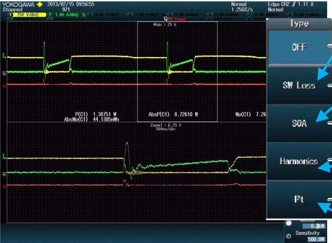
Schaltverlustmessung für Transistoren (SW Loss)
